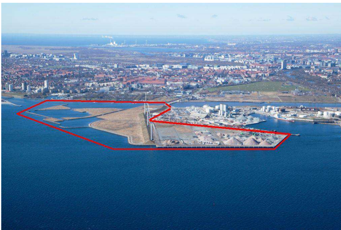
Markeret området omkring Prøvestenen er der deponeret ren og forurennet jord og indvundet et areal på 36 ha. (Foto: KMC Nordhavn).
