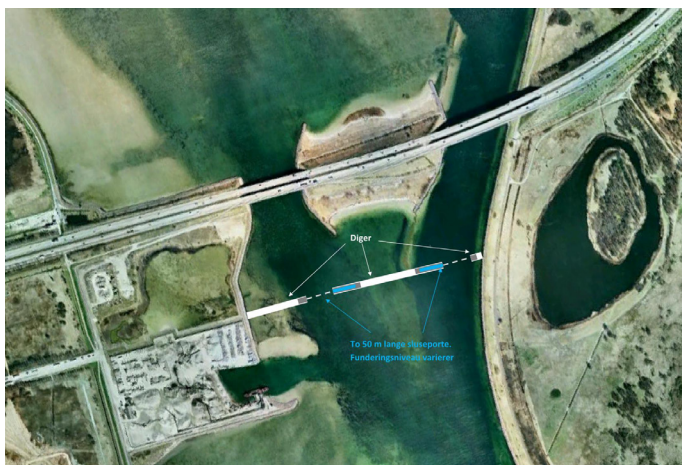
Figur 7: Etablering af sikringsanlæg syd for Kalveboderne.
