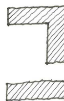
Øverst ses bygning med indadgående bygningshjørne. Nederst en lige bygning, hvis lysforhold ikke er påvirket af indadgående hjørner.
