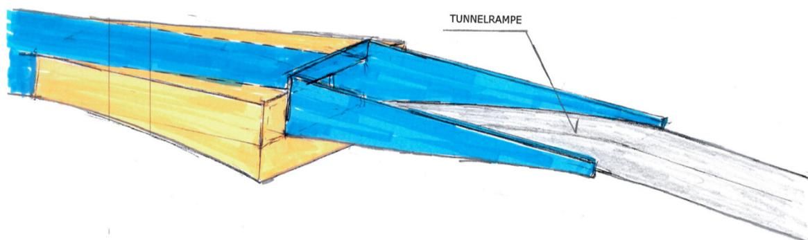
**Figur 3-1 Princip for forberedelse til videreførelse. Det med blå markerede er tunnel og tunnelrampe, svarende til hvad der udføres, såfremt der ikke forberedes for videreførelse. Det med orange markerede er forberedelsen i form af start af kilestrækninger og sænket bundplade.**
