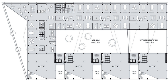
1. etage med gangbroer der forbinder længerne.
