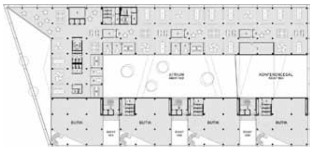
1. etage med gangbroer der forbinder længerne.
