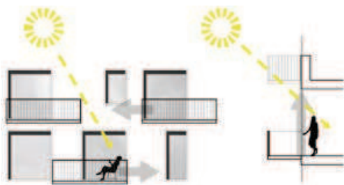
Ill. 7. Forskudte altaner giver facaderne en horisontal fremtoning, der underbygger bygningernes dynamiske form samt skaber sammenhæng og kontinuitet mellem de enkelte bygningskroppe. Forskydningerne sikrer gode dagslysforhold i boligens primære opholdsrum og sol på altanerne. Holscher Arkitekter.
