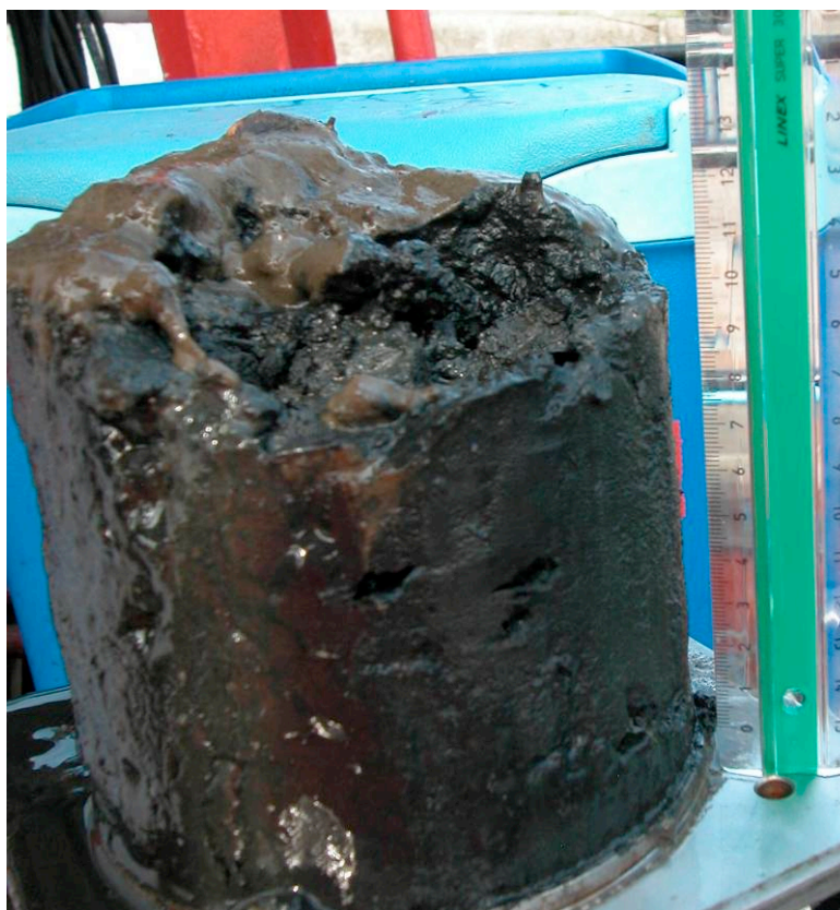
Figur 14-7 Sedimentkerne fra marts 2007 som viser sedimentationen af forårsopblomstringen på overfladen af sedimentet.
