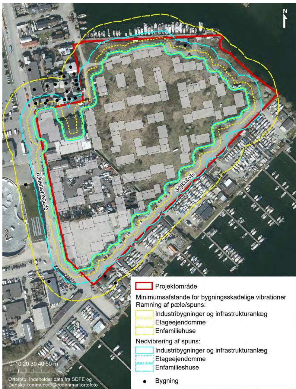
Figur 2-5 Udbredelseskort fra vibrationer fra forskellige funderingsformer.
