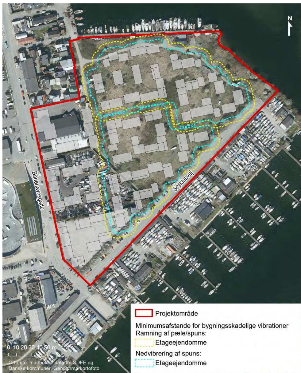
Figur 10-2 Vibrationer fra pæleramning indenfor projektområdet.
