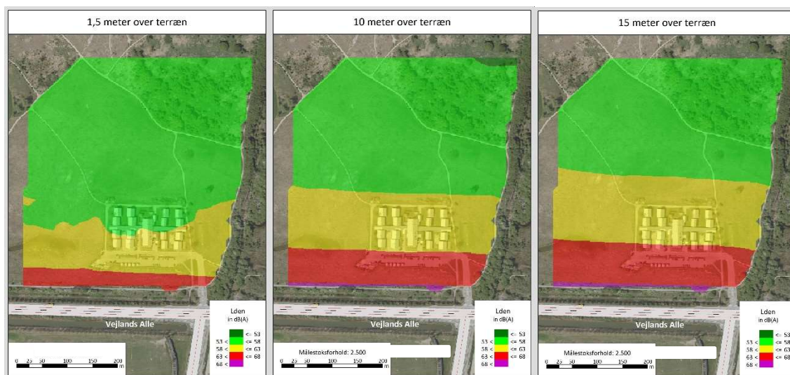
Figur 9.2. Resultat af vejledende støjberegning. Støjkortene viser støjbredden i 3 højder over eksisterende terræn: 1,5 m, 10 m og 15 m.
