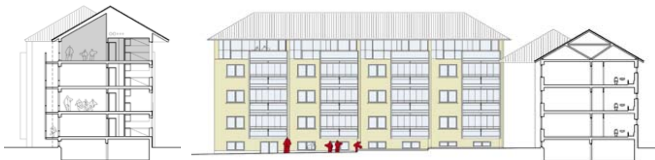
Tværsnit af projekt med den nye tagetage (vist med grå farve).
