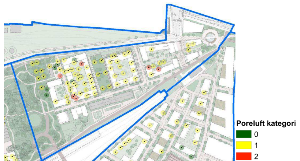
Figur 16-8 Poreluftresultater for delområde 6. Kategorier: 0 = ren (ingen overskridelser af afdampningskriterierne), 1 = forurenet (op til 100 gange over afdampningskriteriet), 2 = kraftigt forurenet (over 100 gange over afdampningskriteriet) (COWI, 2023).
