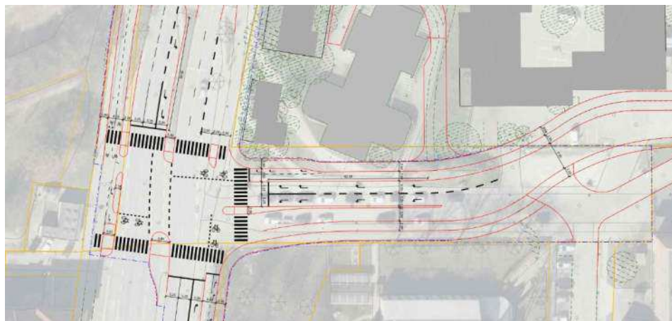
Figur 3-7 Ny krydsudformning for det signalregulerede kryds ved Gl. Vasbygade/ Enghavevej. Der er anlagt svingspor fra Enghavevej ind mod Jernbanebyen. Krydsudformningen anvendes i Scenario 2035.
