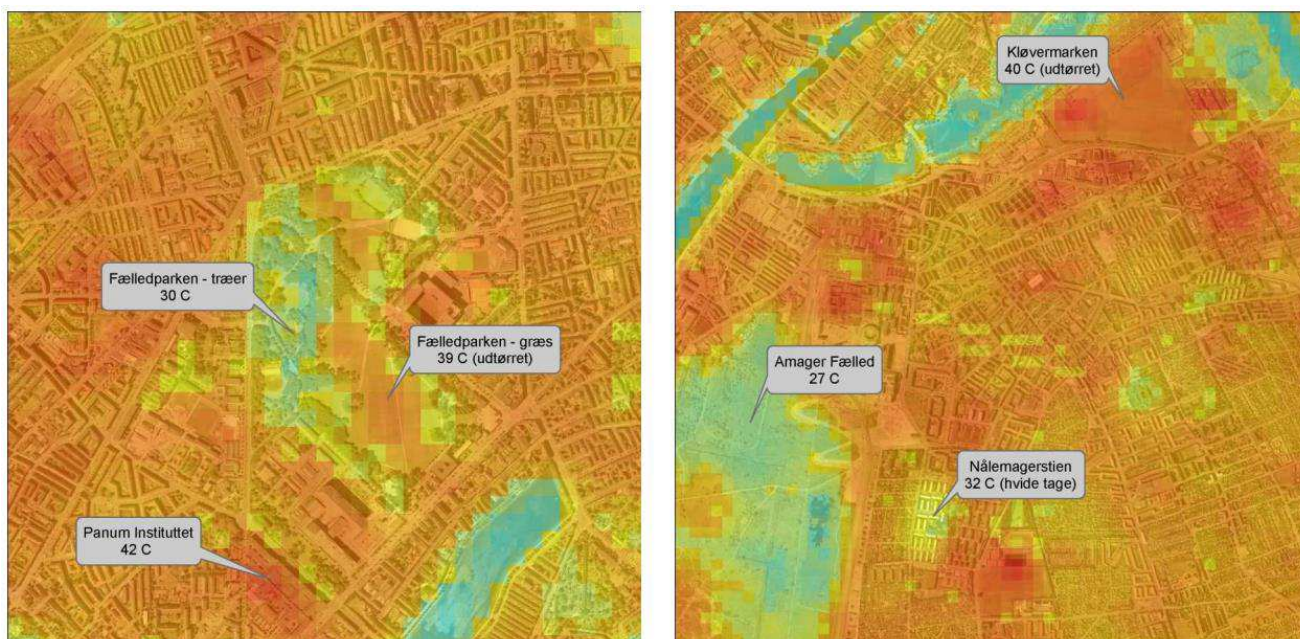
Figur 13-2 Detailudsnit af temperaturkort fra d. 20. juli 2006. Der er zoomet ind på områder i Københavns Kommune (Bühler, 2010)
