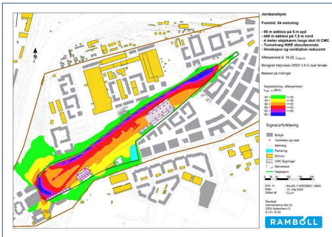
Figur 19-15. Scenarie: Reduceret støj uden overdækning. Beregnet støjniveau 1,5 meter over terrænet i aftenperioden.
