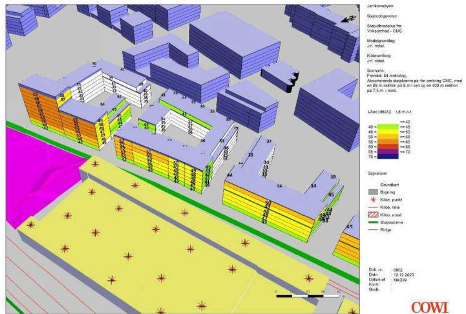
Figur 5-9 CMC. Facadestøjskort delområde 4 (set mod nord) uden støjdæmpende foranstaltninger ved fuld udnyttelse af støjvilkår (COWI).
