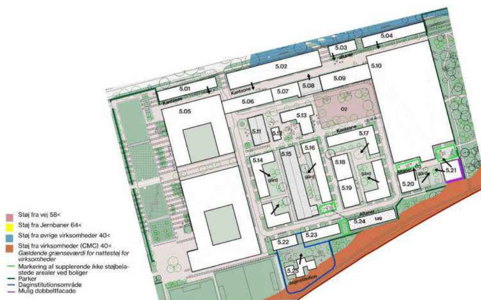
Figur 7-8 Jernbanebyen Delområde 5. Oversigtskort over udbredelse af støj fra veje, jernbaner, CMC og andre virksomheder. Der er kun vist støjudbredelse for områder, hvor støjniveauet er beregnet over Miljøstyrelsens vejledende grænseværdier for støj på udendørs opholdsarealer. Figuren viser ikke støjudbredelse fra boldbanerne.
