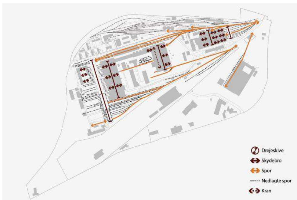
Figur 5-3 Jernbanebyens gridstruktur refererer til de vinkelrette akser, som har været styret af lokomotiver og togvognenes bevægelse gennem området. Bygningsfacader, spor, skydebroer og dermed hele Centralværkstedets funktioner har været organiseret omkring disse øst/vest gående akser og bevægelser nord/syd med skydebroer. Når der refereres i notatet til gridstrukturen i området, så er det denne orientering der henvises til. Illustration Cobe.
