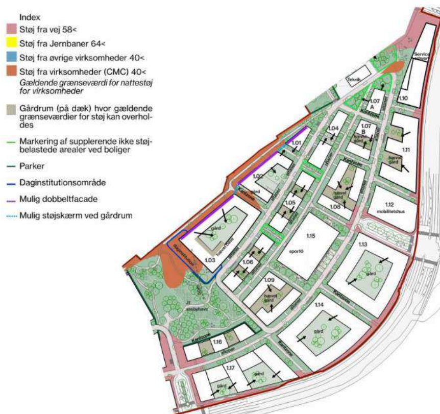
Figur 7-2 Jernbanebyen Delområde 1. Oversigtskort over udbredelse af støj fra veje, jernbaner, CMC og andre virksomheder. Der er kun vist støjudbredelse for områder, hvor støjniveauet er beregnet over Miljøstyrelsens vejledende grænseværdier for støj på udendørs opholdsarealer. Pile angiver adgangsvej til udendørs opholdsarealer.
