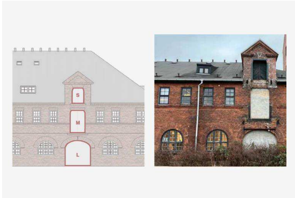
Figur 5-77 Facadens hierarkiske opbygning. Tegning Cobe.
