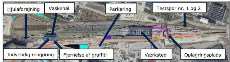
Figur 8-1. Placering af bygninger, spor og områder på CMC Vasbygade ved fremtidig indretning til fuld kapacitet.
