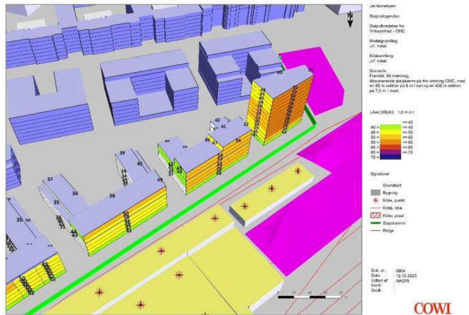
Figur 5-9 CMC. Facadestøjskort delområde 4 (set mod nord) uden støjdæmpende foranstaltninger ved fuld udnyttelse af støjvilkår (COWI).
