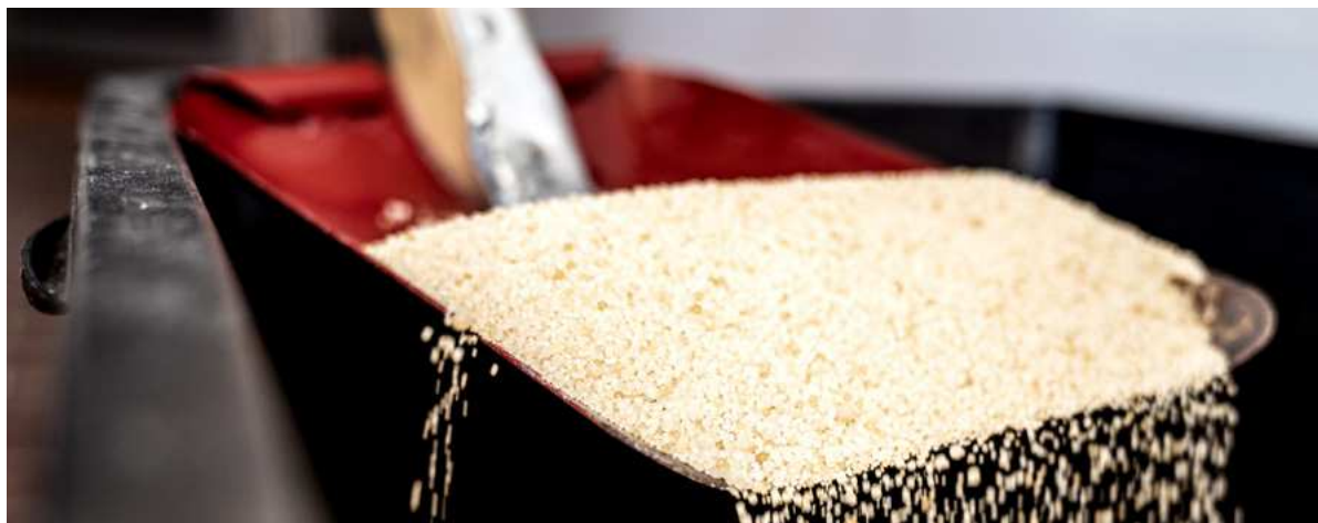
Kalkpellets fra blødgøringsprocessen på Brøndbyvester Vandværk
