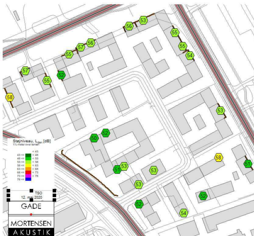
Figur 7-6. Støjniveauer på tagterrasser med 1,8 m høje støjskærme.
