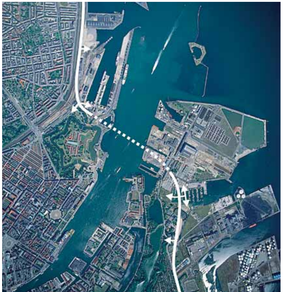
Linjeføring for kort sænkettunnel med tilslutningsanlæg
