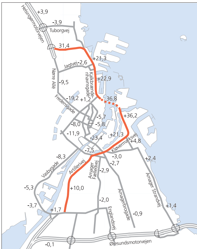
Biltrafik 2010. Ændringer som følge af havnetunnel og trafiksanering af Indre By angivet i 1000'er biler pr. hverdagsdøgn. Havnetunnelen har her en biltrafik på 36.800 biler pr. døgn, mens Knippelsbro aflastes for 23.400 biler pr. døgn.
