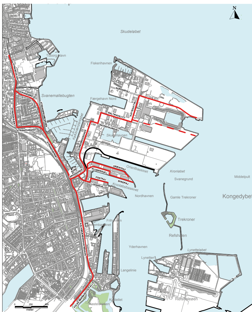
Figur 53 Vejnettet som forventes påvirket af projektet (angivet med rød farve). Der forventes anlagt en ny vej til den nye krydstogtsterminal, som er vist som stiplede på figuren.
