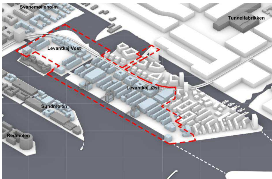
Foreløbig volumenmodel af bygherres forslag til bebyggelsesplan set fra sydøst mod nordvest. De blå bygninger er nye bygninger i det aktuelle lokalplanforslag. De grå bygninger er eksisterende og de hvide er bygherres volumenstudier af de omkringliggende områder. Lokalplanafgrænsningen for Levantkaj er vist med rød stiplede linje. Illustration: Entasis. TMF har på skitsen indtegnet to mulige bud på én mulig forbindelse til Lynetteholm.
