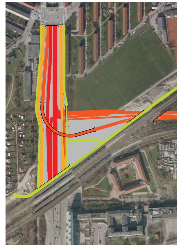
Diagram over veje, broer og planlagte stier i forbindelse med Tilslutningsanlæg IV
