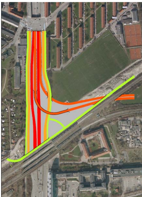
Figur 4.5 Forslag II til tilslutningsanlæg ved Helsingørmotorvejen: Niveaufrie ramper mellem Helsingørmotorvejen og Nordhavnsvej. Rød: Helsingørmotorvejen, Orange: Nordhavnsvej, Gul: Lyngbyvej, Grøn: Fortov og cykelsti.
