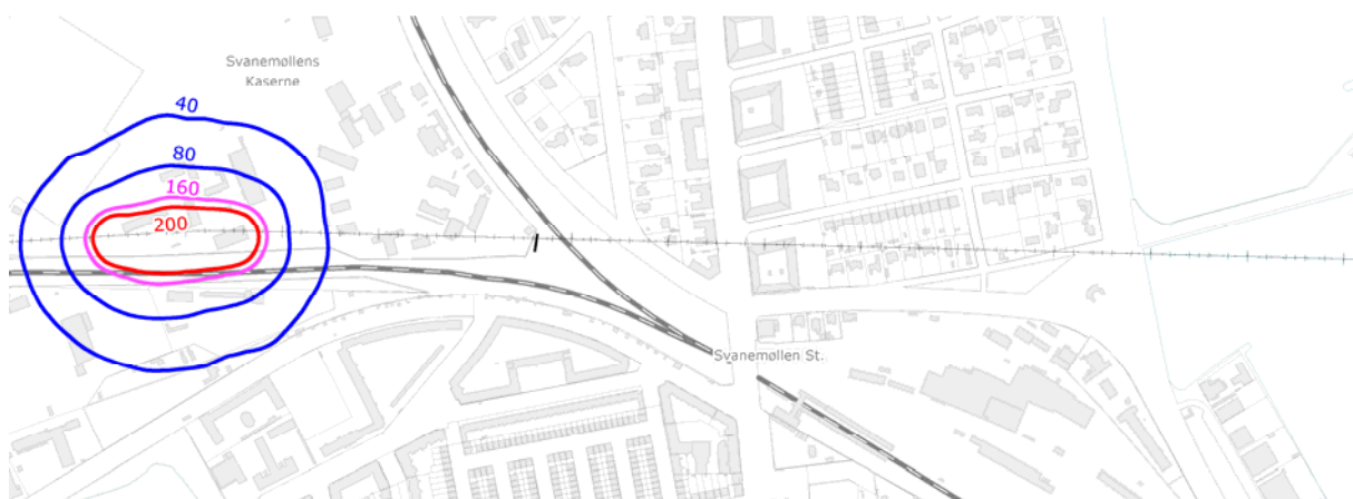
Figur 13.5 Isotimekoncentrationslinier med angivelse af mere end 18 årlige overskridelser af de angivne NO 2 koncentrationer
