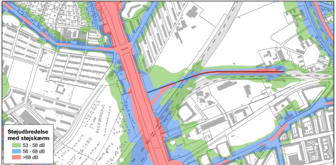
Figur 12.3A Støjudbredelse i korridor omkring Nordhavnsvej som Vejforslag A1. Trafikstøjen er beregnet i 1,5 meters højde over terræn. Scenario med en udbygning 600.000 etagemeter på Nordhavn og 170.000 etagemeter ved Marmormolen. Der forudsat en niveaufri tilslutning med nordvendte ramper ved Helsingørmotorvejen (Forslag I)
