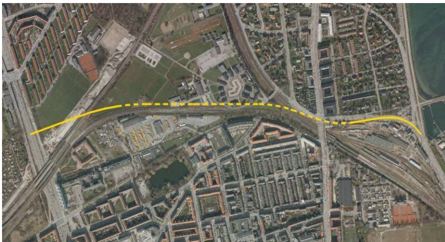
Figur 4.12 Linieføring for Vejforslag A1-1. Tunnelstrækning forlænget ca. 375 mod vest. Vejstrækning i tunnel er stippet, vejstrækning i terræn er fuldt optrukket.
