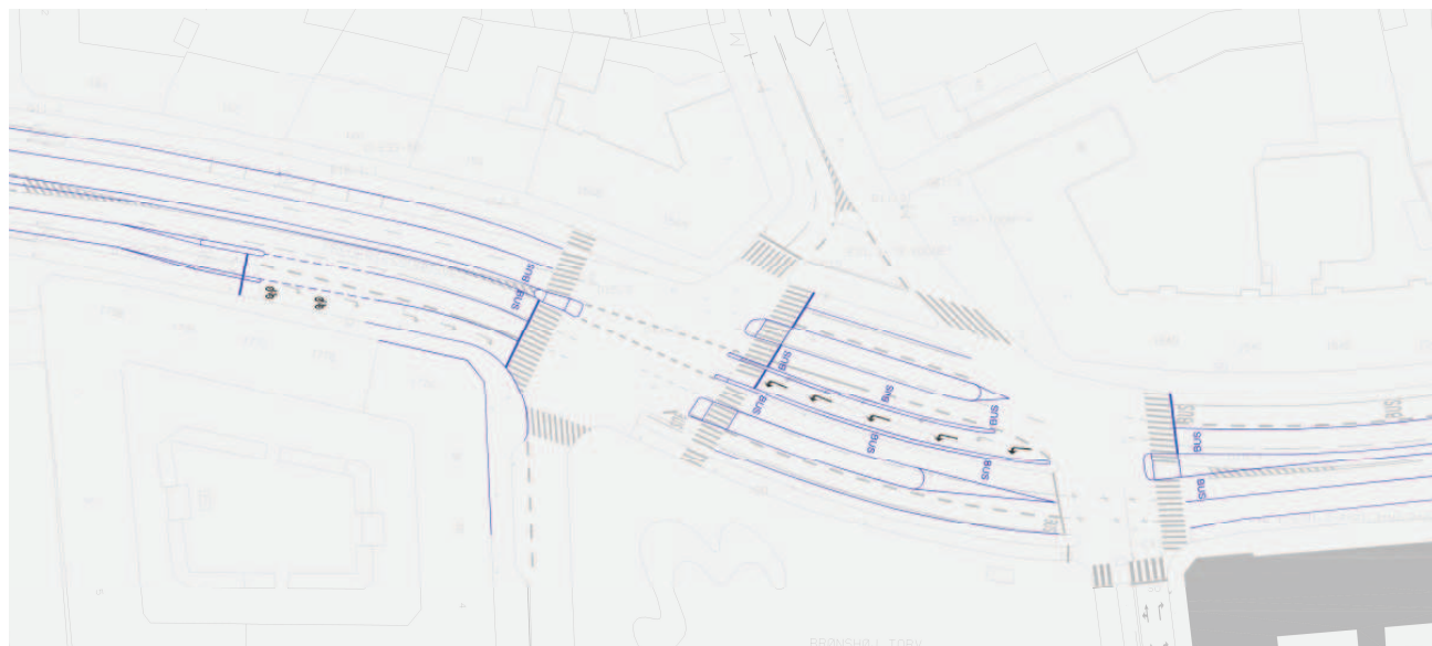
Figur 4.3 Brønshøj Torv. Eksempel på station krydsløsning
