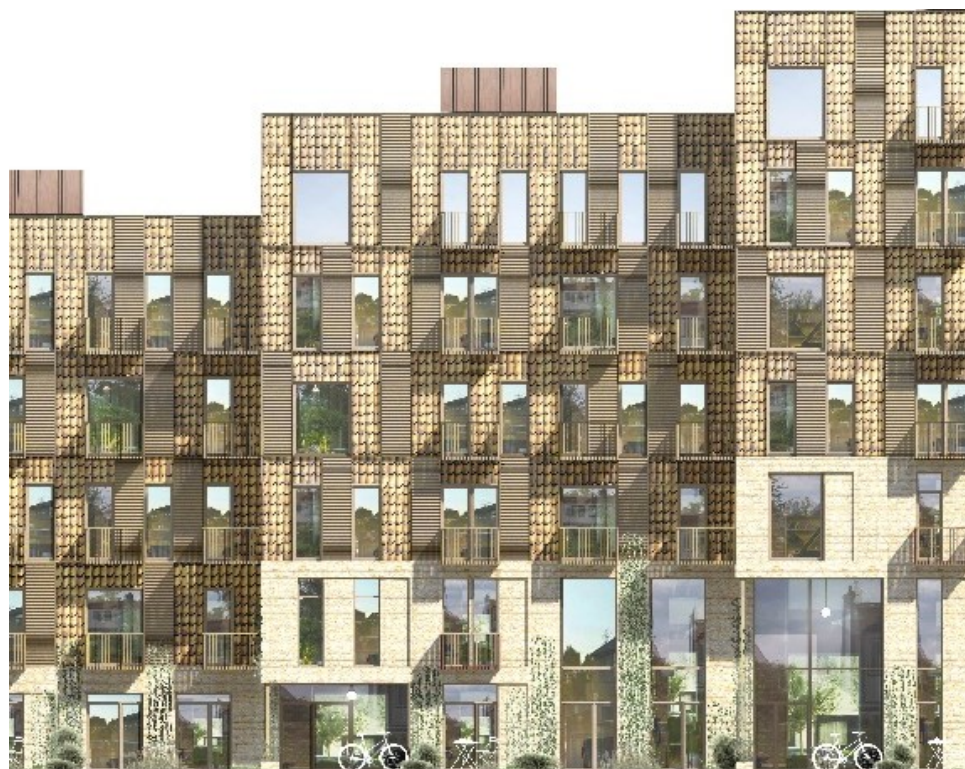
Eksempel på udsnit af bygningsfacade, hvor mindst 15 % af den samlede facade, fratrukket vinduer, skal være i træ. Illustration: SLA og Lendager Group.
