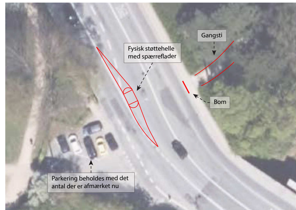
Figur 5-13 // Principskitse af forslag til etablering af en støttehelle ved gangstikrydsningen af Jernbane Allé. Hellen placering er tilpasset arealet på stedet og derfor må fodgængere til/fra stien mod nord gå en kort strækning på fortovet for at komme til den forbedrede krydsning. Stiens møde med Jernbane Allé fra nord kan flyttes, men det er ikke umiddelbart nødvendigt. Begrundelsen for at stien forskydes ved krydsningen er at fodgængerne ikke skal gå direkte ud på vejen, for at fodgænerkrydsningen ikke slutter midt i parkeringsområdet, samt for at undgå at fjerne en del af hækken. Denne udformning gælder kun scenarie 3 hvor der ikke er cyklister der skal krydse. Ved scenarie 1 er stien og dermed støttehellen bredere.
