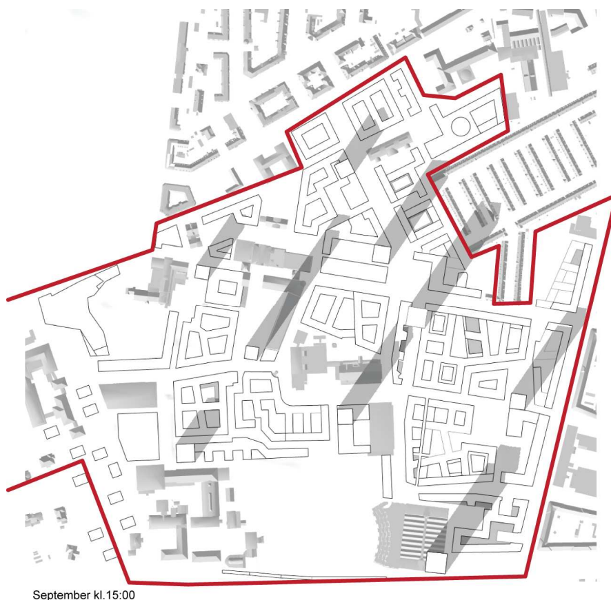
Figur 9-10 Eksempel på skyggediagram for højhusene, fra kl. 15:00 i september.
