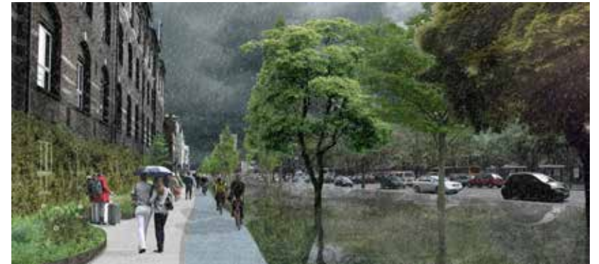
Fig. 11b Ved et kraftigt skybrud håndteres regnen ved at midterrabbatten og en kørebane oversvømmes. Det vil forsat være muligt både at cykle og køre bil.
