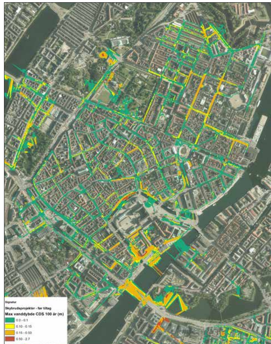
Fig 1 Indre By. Terrænoversvømmelser ved 100 års regn. Orange og rød viser, hvor vandstanden kan forventes at overskride 10 cm i forbindelse med skybrud
