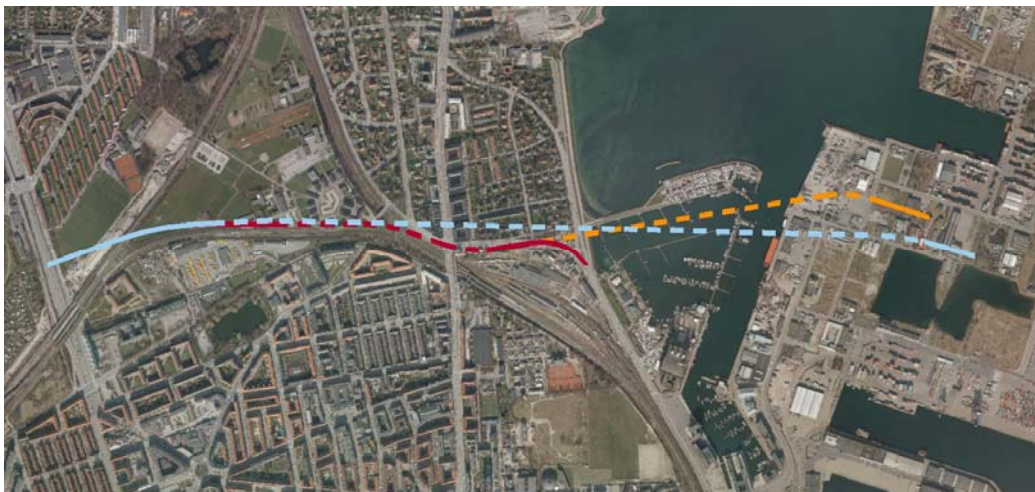
Figur 2.1 Linieføring for hovedforslag til Vejforslag A1 (rød), Vejforslag A2 (orange) og Vejforslag B (blå). Stiplet line er vej i tunnel, fuldt optrukket linie er vej i terræn.
