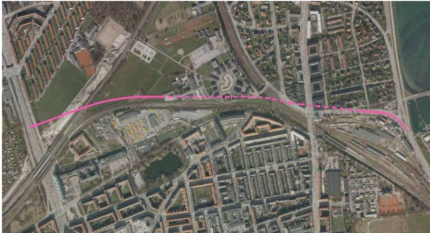
Figur 7.4 Linieføring for Vejforslag A1-4. Passagen under Nordbanen/Kystbane og Strandvejen udføres som en boret tunnel. Vejstrækning i tunnel er stipleet, vejstrækning i terræn er fuldt optrukket.
