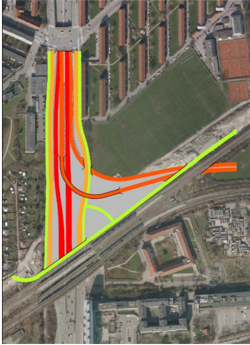
Figur 4.5 Forslag II til tilslutningsanlæg ved Helsingørmotorvejen: Niveaufrie ramper mellem Helsingørmotorvejen og Nordhavnsvej. Rød: Helsingørmotorvejen, Orange: Nordhavnsvej, Gul: Lyngbyvej, Grøn: Fortov og cykelsti.
