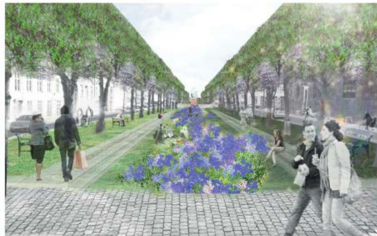
Sankt Annæ Plads set fra vest. Det brede grønne tværprofil med blomstrende bede og plads til ophold på bænke og i græsset. I midten et forsænket område mellem rækkerne af granitsten. Her samles vandet fra ekstreme regnsky. Det ledes østover og det sidste stykke i rør og ud i havnen. I hver side af pladsen er der en ensrettet cykelgade til biler og cyklister samt brede fortove.
