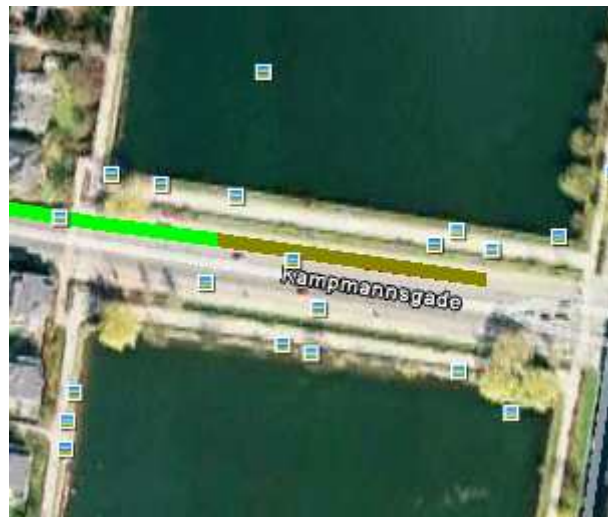
Figur 6 Jævnhedsmåling i den nordlige vejside. Lys grøn: BPI < 12 , Olivengrøn: 12 < BPI < 15 og rød: BPI > 15
