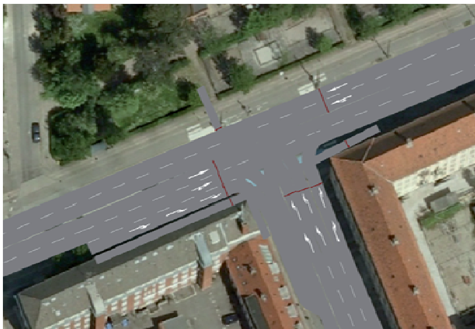
Figur 3.9 Krydset Jernbane Allé - Jyllingevej med busbaner.
