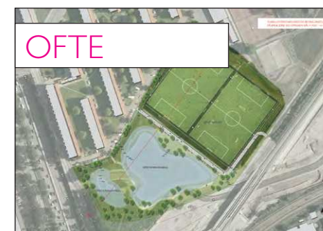
Figur 18. Ved etape 2 kan den etablerede sø forsat anvendes til opstuvning af regnvand. Pga. de nye tunnelrør er der ikke brug for at kunne opstuve samme vandmængder som under etape 1.
