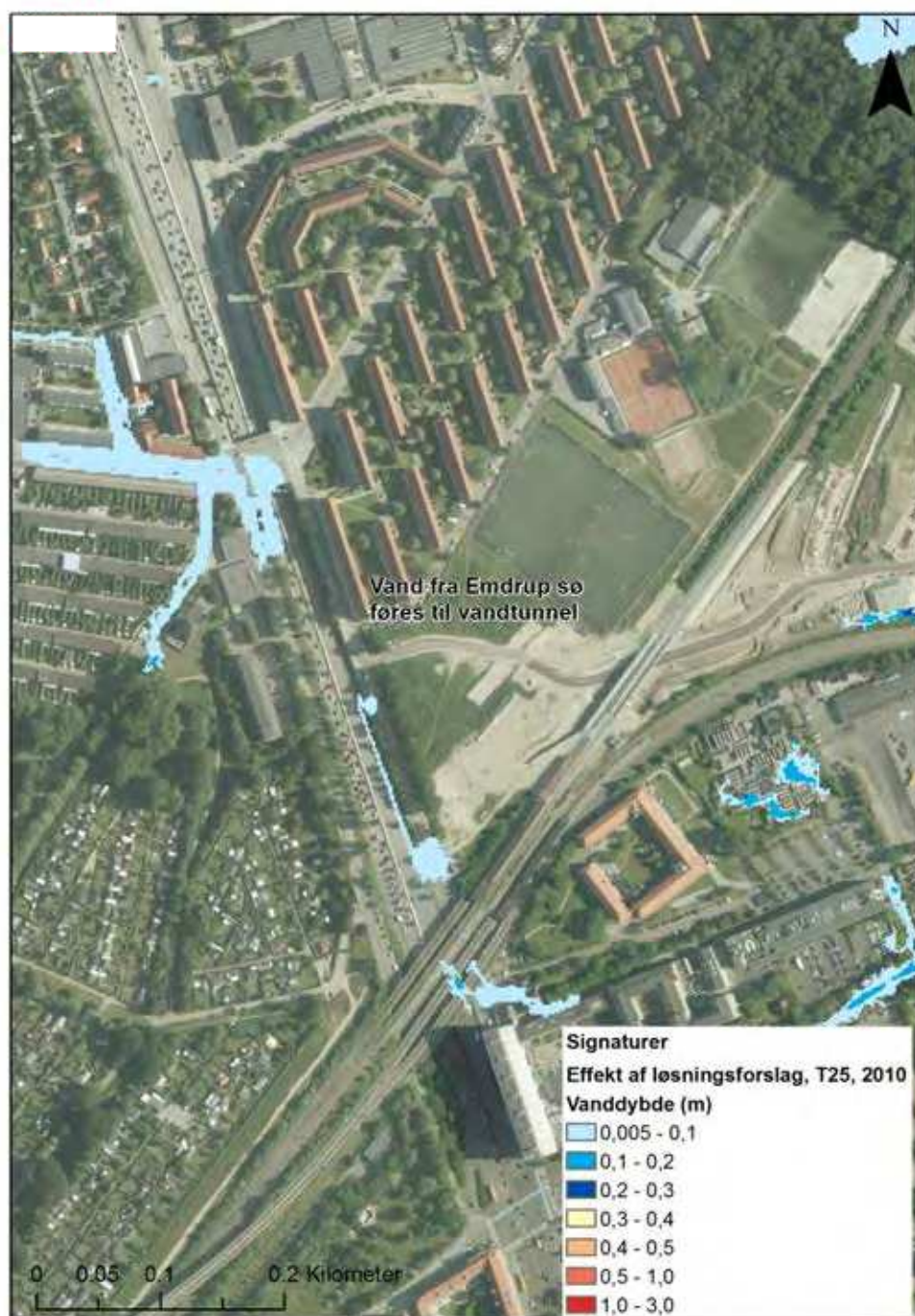
Figur 5-21 Oversvømmelser ved Lyngbyvej/Helsingørmotorvejen efter tiltag for 25 års regnhændelse i 2010.
