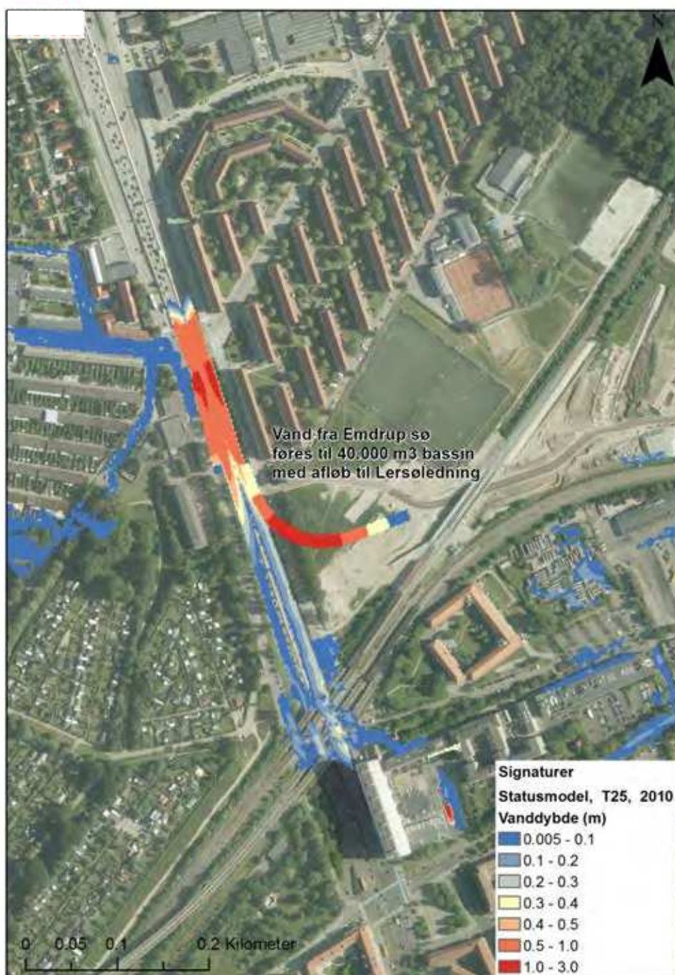
Figur 5-20 Oversvømmelser ved Lyngbyvej/Helsingørmotorvejen før tiltag for 25 års regnhændelse i 2010.
