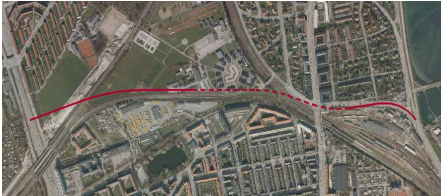
Figur 4.9 Linieføring for Vejforslag A1. Vejstrækning i tunnel er stipleet, vejstrækning i terræn er fuldt optrukket.
