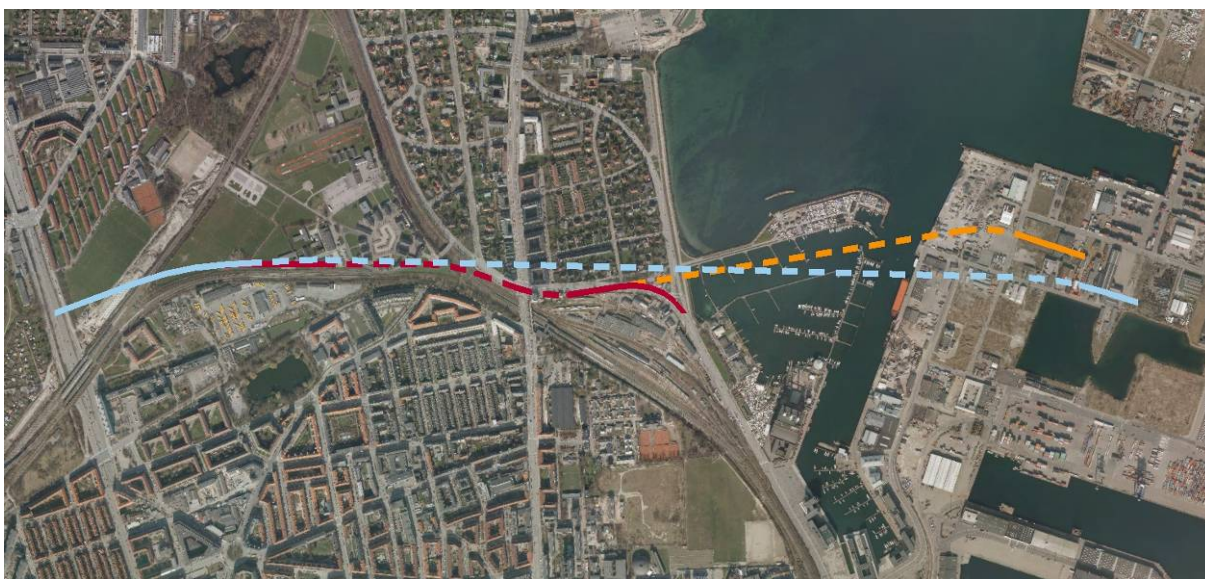
Figur 4.1 Linieføring for hovedforslag til Vejforslag A1 (rød), Vejforslag A2 (orange) og Vejforslag B (blå). Stiplet line er vej i tunnel, fuldt optrukket linie er vej i terræn.
