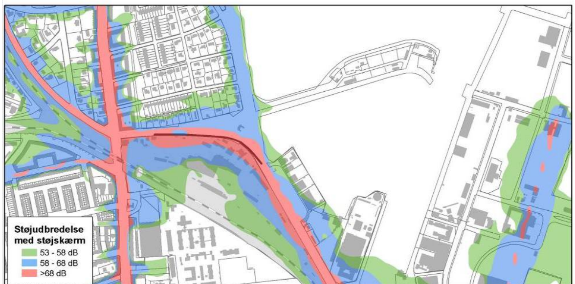
Figur 12.4 B Støjudbredelse i korridor omkring Nordhavnsvej som Vejforslag A1. Trafikstøjen er beregnet i 1,5 meters højde over terræn. Scenario med en udbygning 600.000 etagemeter på Nordhavn og 170.000 etagemeter ved Marmormolen. Der forudsat en niveaufri tilslutning med nordvendte ramper ved Helsingørsmotorvejen (Forslag I).
