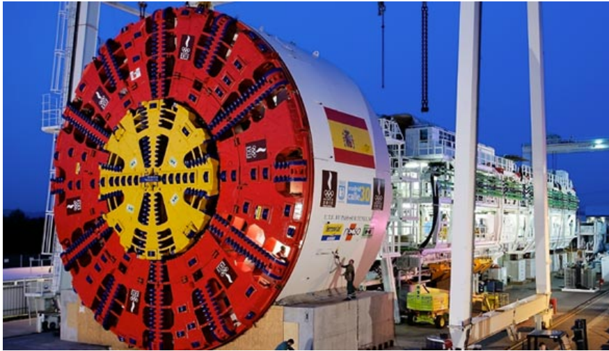
Figur 6.23 EPB tunnelboremaskine med diameter 15,2. Fra projekt M30 i Madrid.
