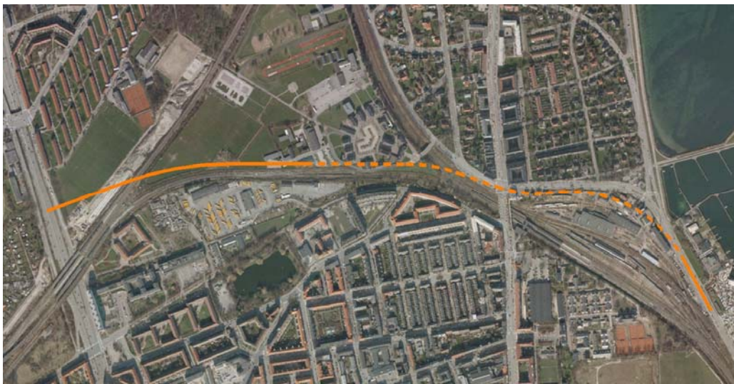
Figur 5.4 Linieføring for Vejforslag A1-3. Tunnelstrækning forlænget ca. 400 m mod øst i Strandvænget. Vejstrækning i tunnel er stiplede, vejstrækning i terræn er fuldt optrukket.
