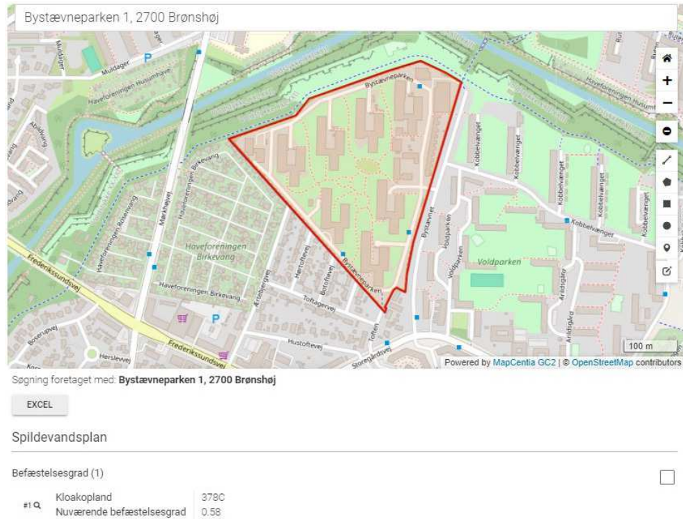
Figur 12-1 Udklip fra Københavns Kommunes spildevandsplan "min matrikel", som oplyser om kloakopland og nuværende befæstelsesgrad.
