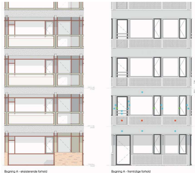
Figur 7-41 Illustrationen viser eksisterende facade til venstre og fremtidige facader til højre på rehabiliteringscenteret Hasselbo. Rehabiliteringscenteret, som i dag har adresse på Bystævnet 17-18, bevares og saneres. Illustration Klaus Nielsen A/S.
