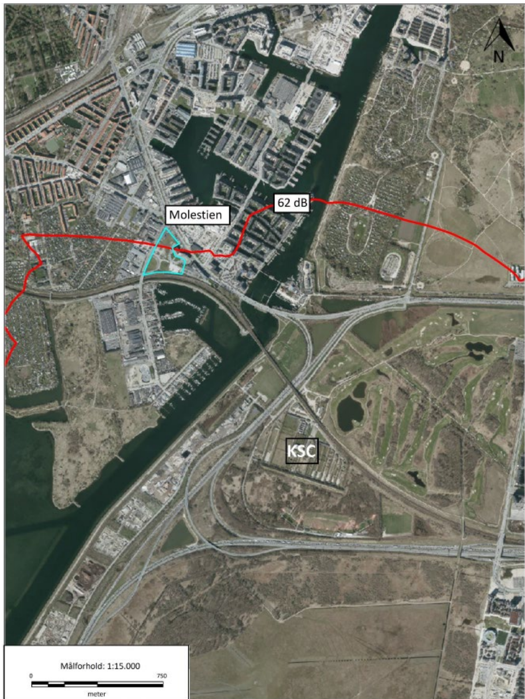
Figur 7-2: Støjdbredelse fra Københavns Skyttecenter (KSC) under eksisterende forhold.
