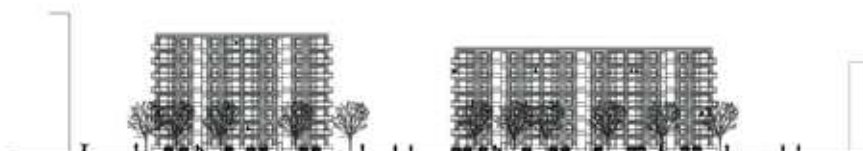
Boliger øst for grønningen. Facader med tunge og lette partier med gennemførte lodrette og vandrette markeringer.
