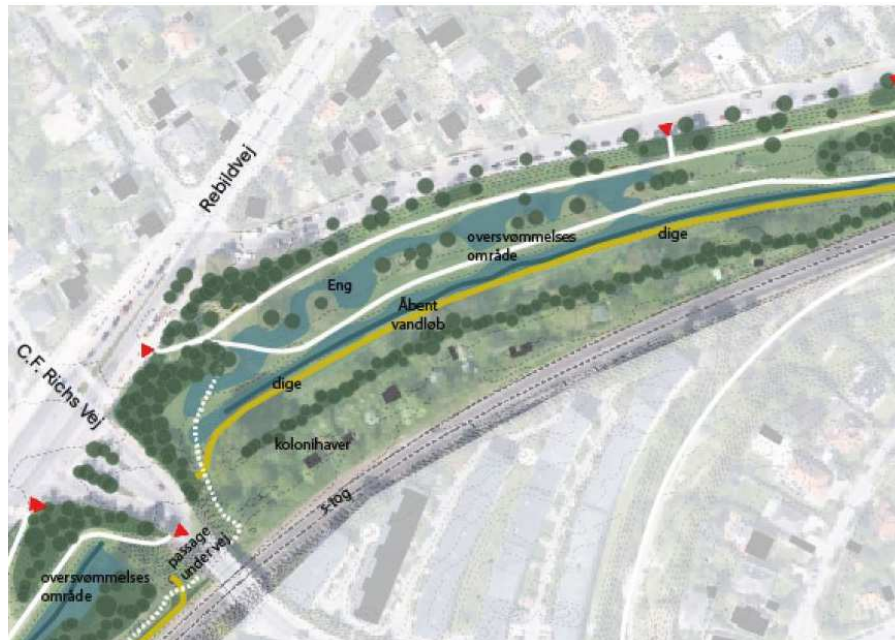
Planudsnit af delområde 2, der viser udbredelse af hyppige opstuvninger fra Fremtidens Grøndalspark idéoplæg 2024
