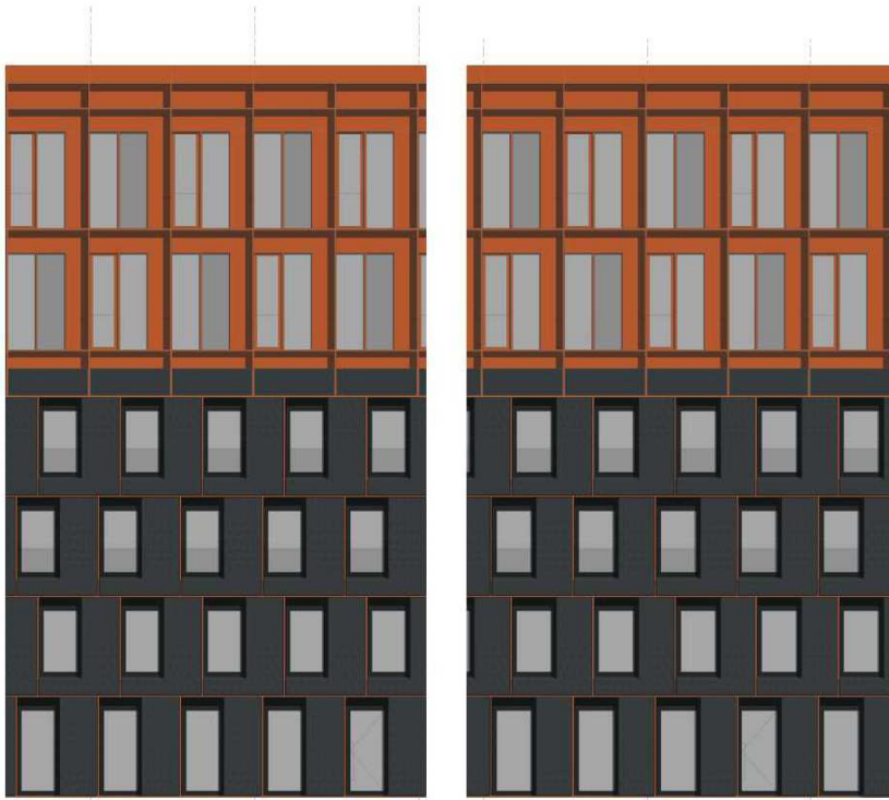
Illustration: t.h. model a) med glasbredde 900 mm, t.v. model b) med glasbredde 950 mm.
