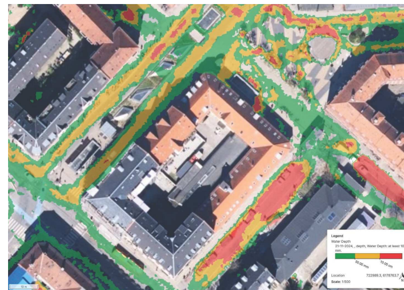
Figur 7. Detaljeret resultat af vanddybder i Haraldsgade. Resultat fra plan model, hvor rød er vanddybder over 10cm.
