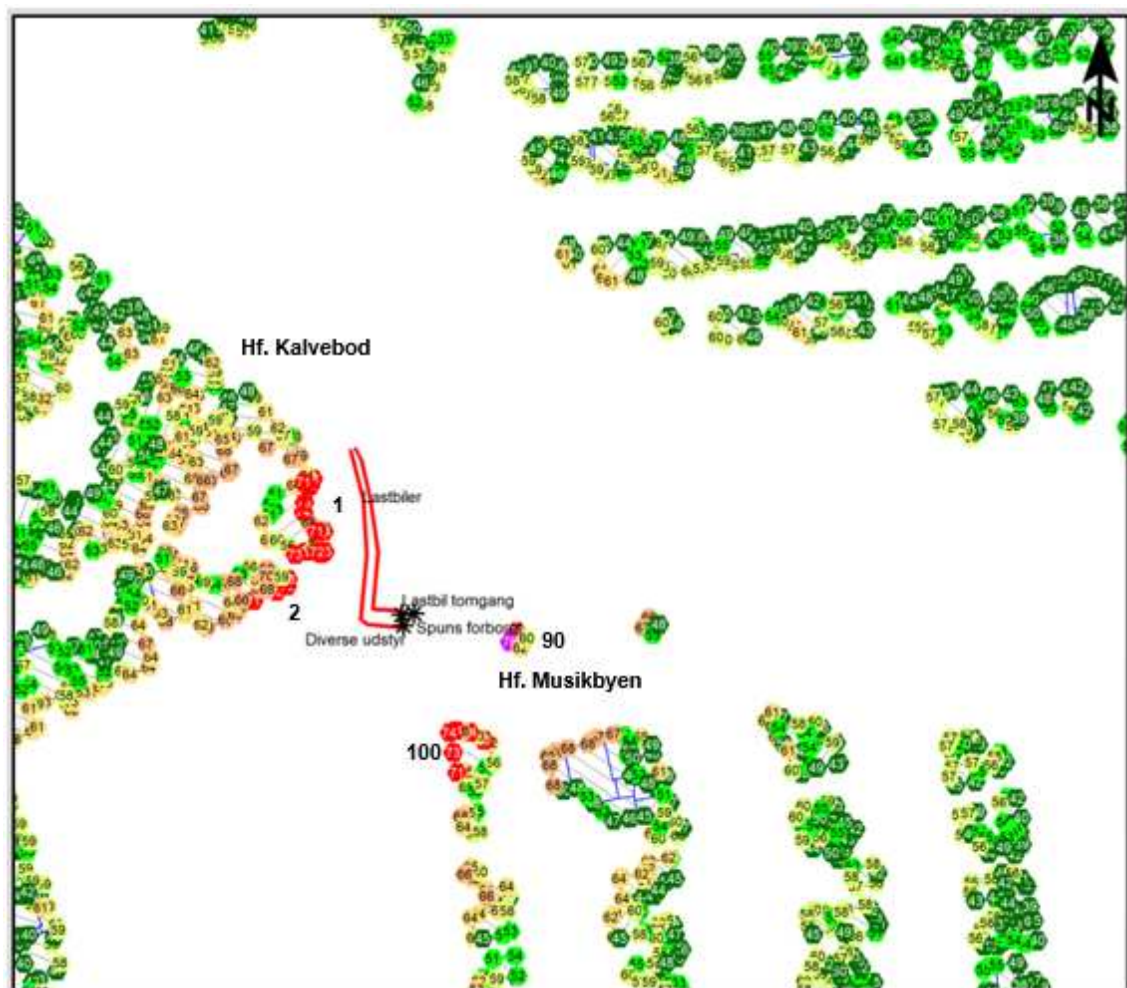
Figur 9.17: Støj fra anlægsarbejder i byggefase 8a for byggepladsen ved Musikbyen, hvor der etableres vægge til tilslutningsbygværk. Støjkortet medtager ikke tillæg for hørbare impulser på 5 dB. Tal angiver numre på havelodder.
