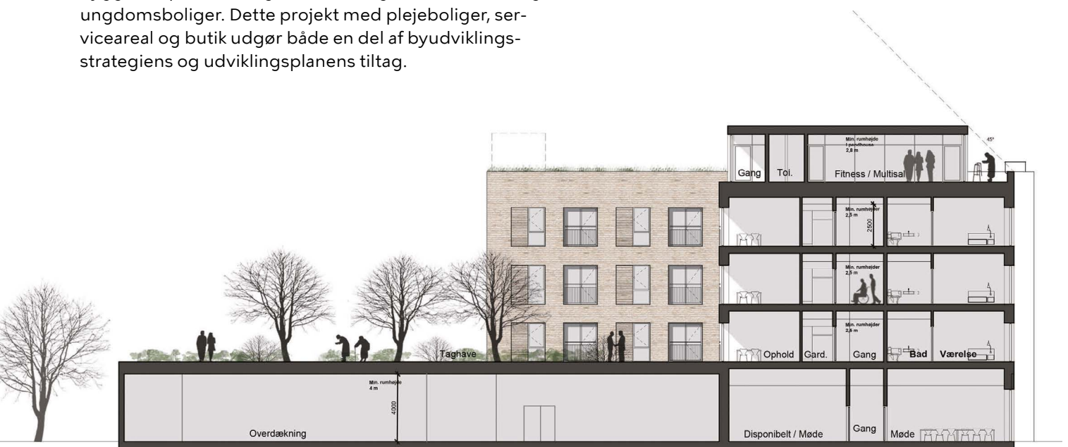
Snit gennem bygningen, hvor man kan se funktionerne på de forskellige etager
