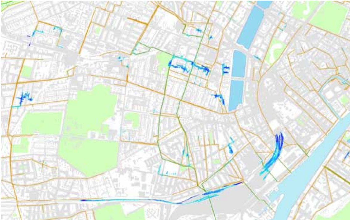
Figur 5: Oversvømmelser ved en 100-årsregn i 2110 med klimatilpasningstiltag.
