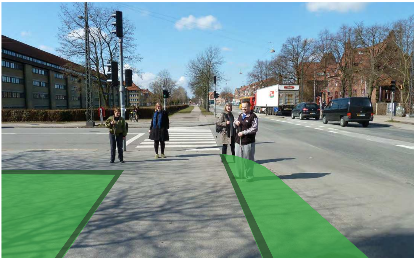
Løsning 19_1: Plantebede, evt afgrænset med chausséstensbånd markerer gangbanen frem til krydset
