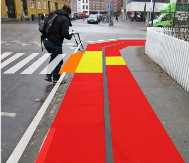
Løsningsforslag 18_1a: Asfaltfortov erstattes af Københavnerfortov
