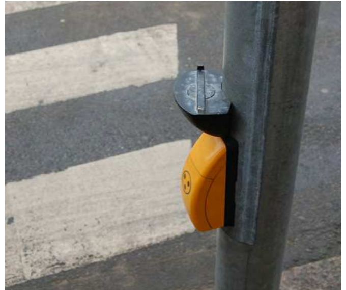
Foto der viser akustisk signal med retningsviser i toppen - Hér hvor der ikke er midterhelle.
