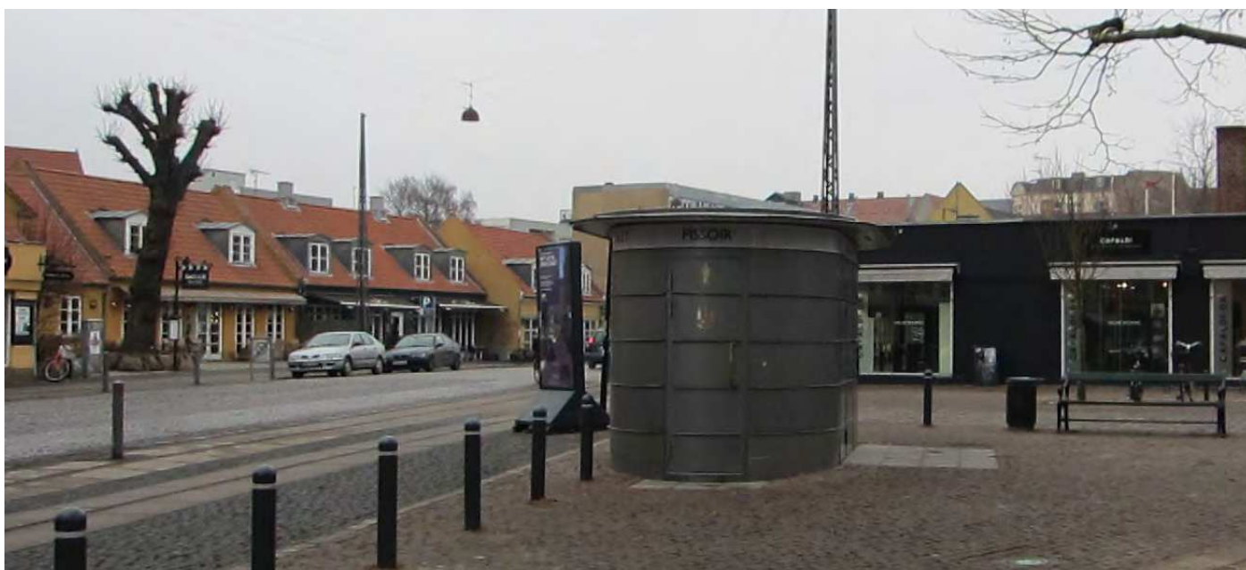
Foto der viser problem 13_6: Manglende ganglinje til det offentlige toilet
