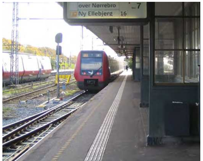
Løsningsforslag 03_1: Betonledelinje nedfældet i asfalt (Hellerup Station).
