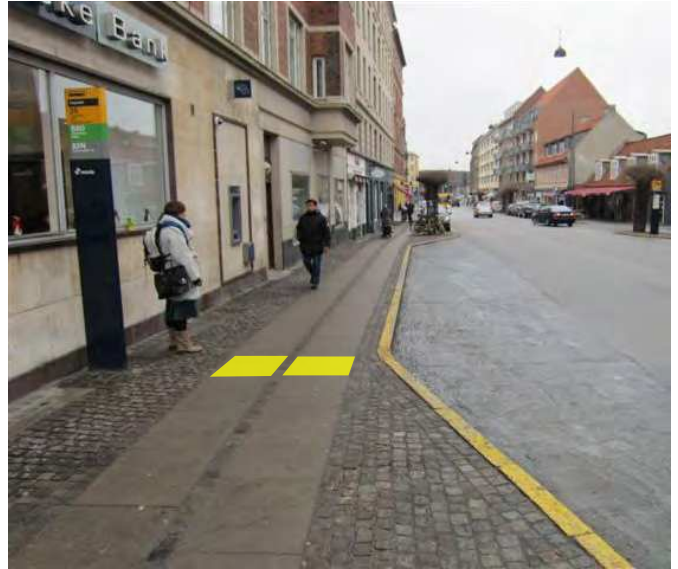
Løsning 07_1: Opmærksomhedsfelt anlægges.
