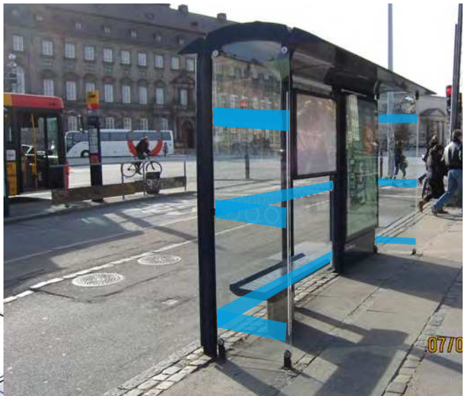
Løsning 07_5 og 07_7: Buslæskærm påføres glasmarkering (referencefoto).
