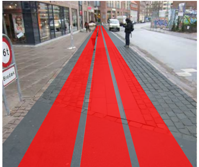
Løsningsforslag 03_2: Mod pladsen til højre etableres en række chaussésten. Et nyt Københavnerfortov anlægges.
