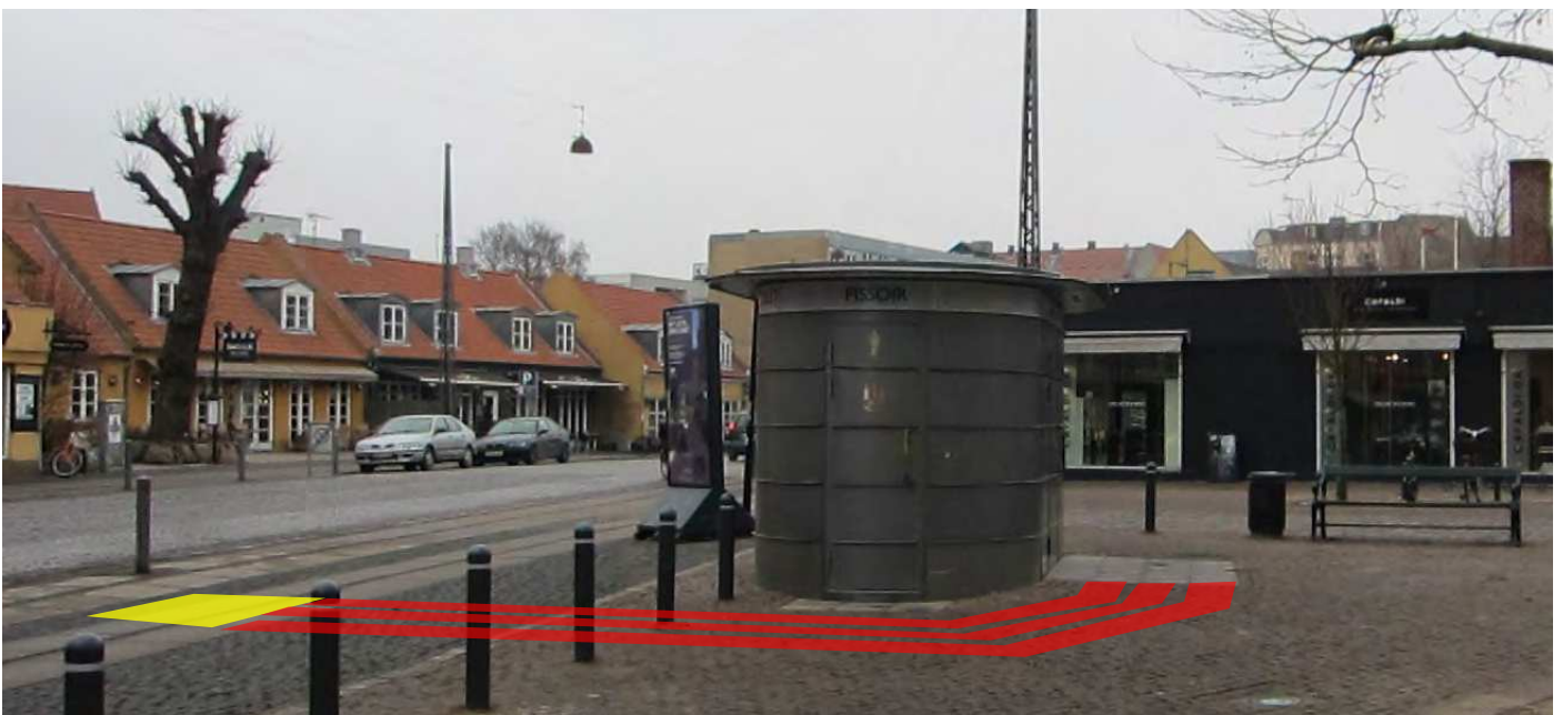
Løsning 13_6: Etablering af jævn gangbane med ledelinie, der fører til det offentlige toilet
