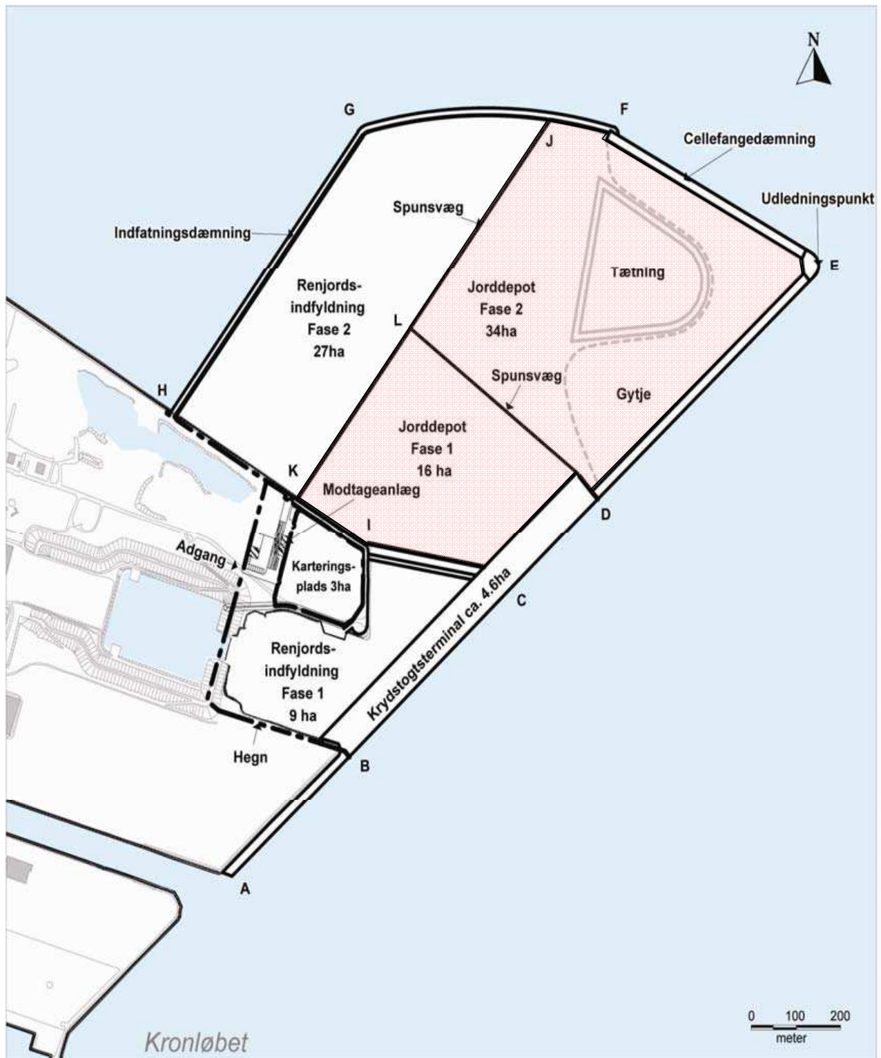
Principskitse af områdets indretning. Depotet for forurennet jord er markeret med rødt og er ca. 50 ha.
