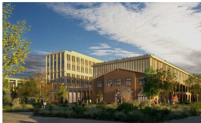
Visualisering, der viser et eksempel på et nybyggeri i overensstemmelse med tillægget set fra 'Den grønne Kile'. Til venstre ses pergola med integreret støjskærm i glas samt nybyggeriet langs Scandiagade. Til højre ses den eksisterende bygning med ny ekstra etage. Illustration: entasis.
