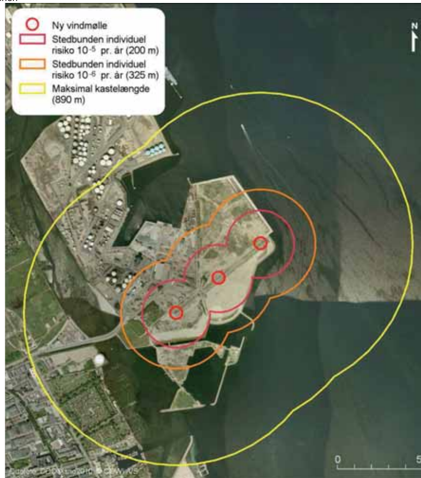
Figur 7.2 Maksimal kastelængde (nedfaldsområde) og afstand til stedbunden individuel risiko på 1 \times 10^{-6} pr. år og 1 \times 10^{-5} pr. år for 3 vindmøller med totalhøjde op til 115m.
