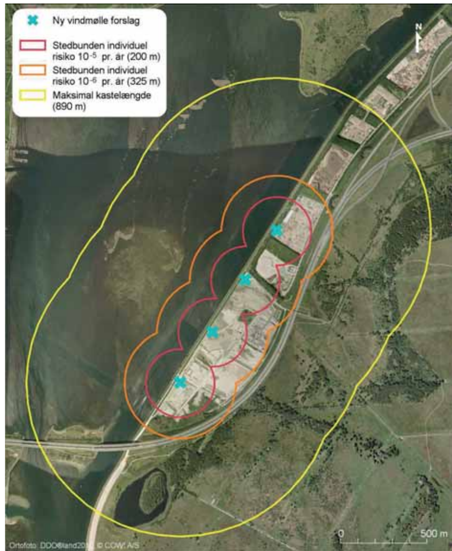
Figur 7.3 Maksimal kastelængde (nedfaldsområde) og afstand til stedbunden individuel risiko på 1 \times 10^{-6} pr. år og 1 \times 10^{-5} pr. år for vindmøller på Kalvebod Syd (Alternativ A). Der er ingen forskel i de beregnede kastelængder for de to mølletyper. Alternativ A og B er derfor identiske hvad angår kastelængde.
