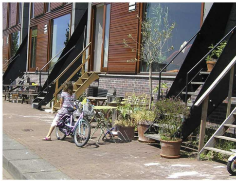
Referencefoto jf. § 7, stk. 1. Eksempel på smal kantzone med trapper, der trækkes frem fra facaden og skaber en semiprivat zone, som kan indtages af beboerne. Referencefoto fra Amsterdam. Byens Udvikling.
