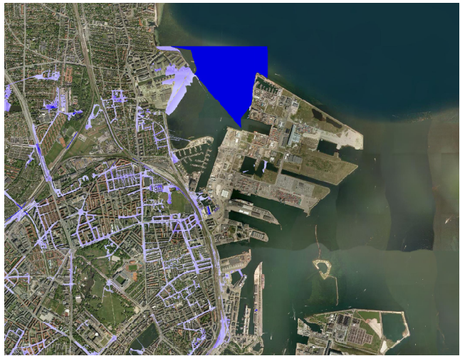
Figur 1: Regnvand. Beregnede potentielle oversvømmelsesområder ved en hundrede-års hændelse om hundrede år, uden klimasikring og under forudsætning af at de anvendte prognoser for udvikling i klimaet holder stik. Kortudsnit fra COWI 2008.
